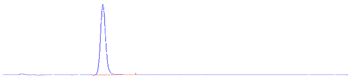
图A. 1 苯并三氮唑标准溶液的高效液相色谱图
